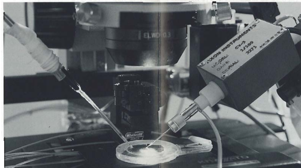
マイクロインジェクション装置 カエル卵母細胞へ遺伝子を注入し、細胞表面に発現される蛋白質の性質から、目的とする蛋白質をコードする遺伝子の構造を追跡する。
