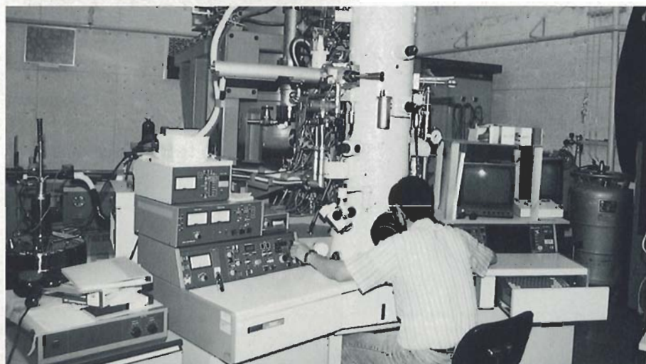
極低温電子顕微鏡 世界で最も高分解能(2Å)の極低温(1.5ケルビン(K)液体ヘリウムの温度より低い)で構造を解析出来る電子顕微鏡。他の方法では困難な受容体など膜蛋白質の構造解析が出来る。本研究所で設計された装置である。
