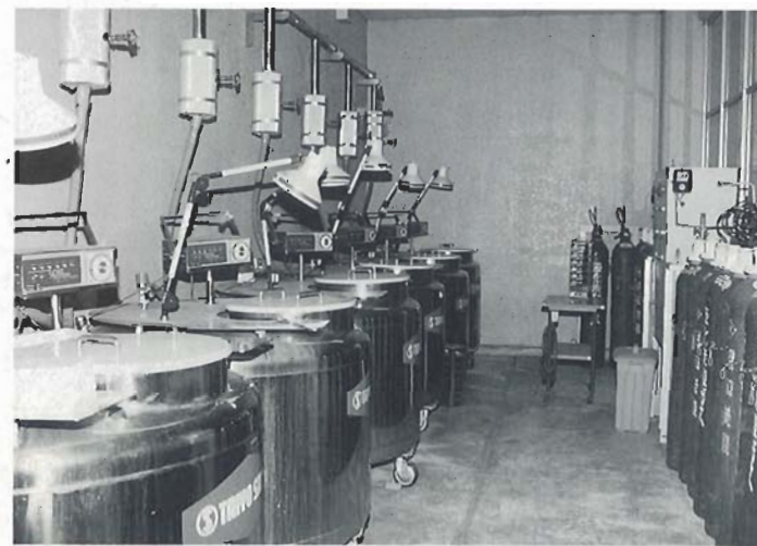
◀細胞保存用の液体窒素タンク 数万種類の細胞が液体窒素中で凍結保存されており、必要時に解凍し培養を再開できる。
