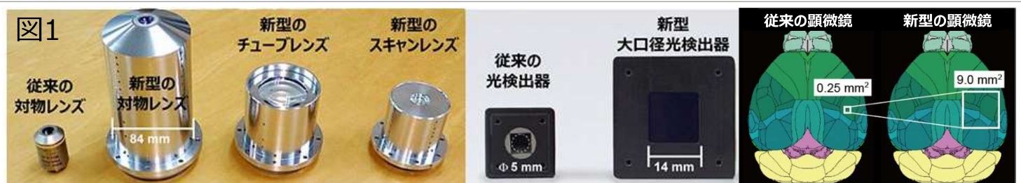
左,中：低倍率かつ高開口数を実現する巨大レンズと大口径で高感度な光検出器（GaAsP-PMT）を共同開発。 右：従来の顕微鏡では視野が小さすぎて、マウスの脳を用いたとしても1脳領域の一部分しか観察できなかった。
